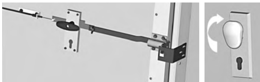
Рис. 7. Разблокировка электропривода снаружи помещения
