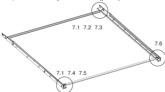
Рис. 7. Вертикальная рамка несущего каркаса ворот в сборе
