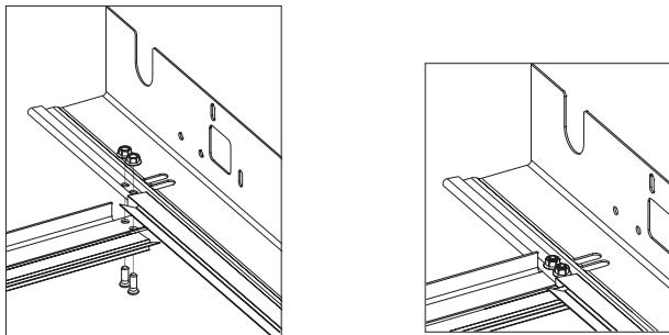
Рис.7.3. Установка нащельника
