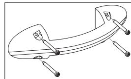
Рис. 39.1. Установка ручки. Вид изнутри
