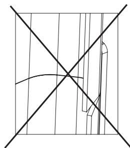
3) зафиксировать направляющую в горизонтальном положении при помощи вспомогательных стоек или за счет подвеса на веревке к элементам конструкции потолка.
