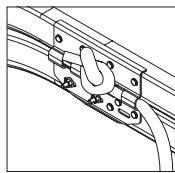
Рис. 42. Крепление каната к направляющей
