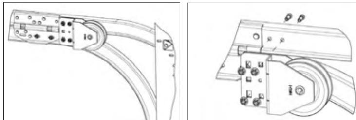
Рис. 43. Крепление блока НКУ-1 к горизонтальной направляющей
