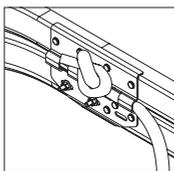
Рис.46.1. Крепление каната к направляющей
