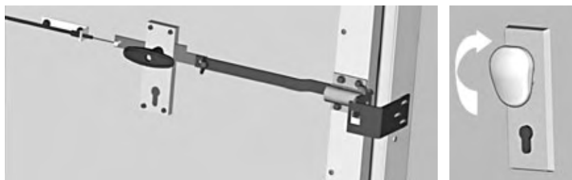
Рис. 7. Разблокировка электропривода снаружи помещения
